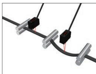
检测橡胶带的拉紧·下垂程度
